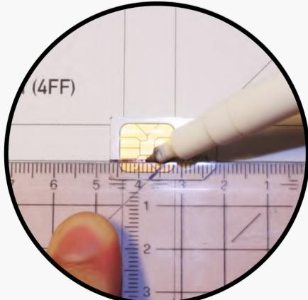
3. Χρησιμοποιείστε έναν χάρακα για να σημαδέψετε τα σημεία κοπής σύμφωνα με τις γραμμές του οδηγού
